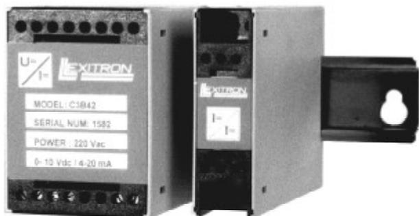
La gama de convertidores de señal para carril DIN nos permiten la amplificación o conversión de señales analógicas. Estos elementos funcionan como interface obteniendo una salida normalizada a partir de las señales de diversos sensores. Dos potenciómetros multivuelta nos permiten el ajuste de 0 y span.
