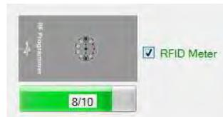
Para chequear el nivel de potencia de la base inalámbrica 0.. 10
