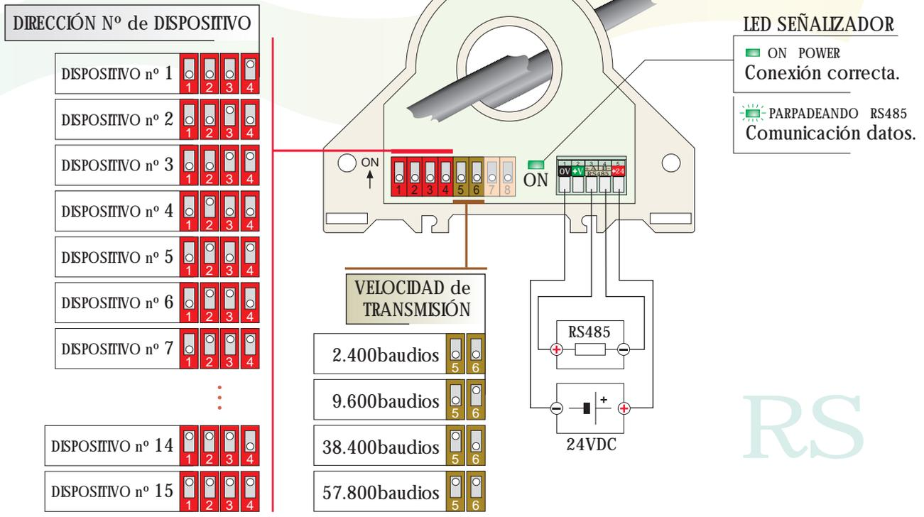
**MODO MANUAL** | Mediante los microswitches se seleccionan manualmente los parámetros estándar fijos de comunicación (nº de dispositivo, velocidad) y señal analógica (25/50A - 150/300A y tipo de intensidad).
